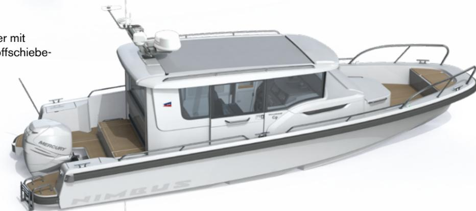
C9 Außenboarder mit Glasschiebedach manuell zu öffnen (inkl. Sonnenschutz)
